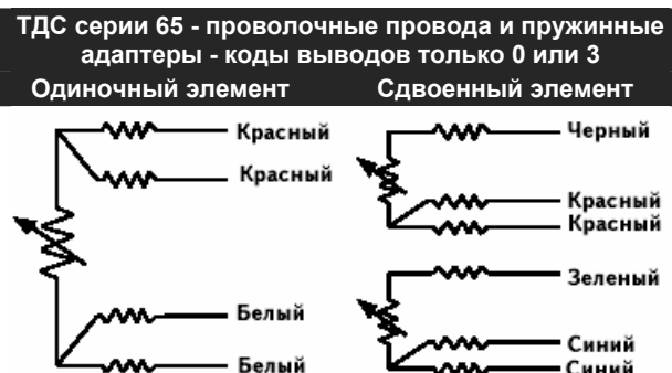
Рисунок 2. Конфигурация соединения проводов ТДС серии 65 и ТПС серии 185
